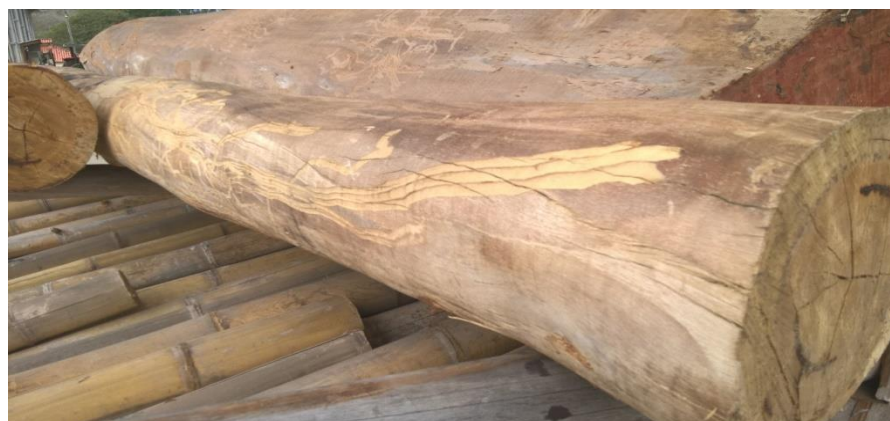
Figura 8 - Tora de Eucalyptus spp. danificadas por insetos deterioradores Phoracantha spp. IF, UFRRJ, 2017.
