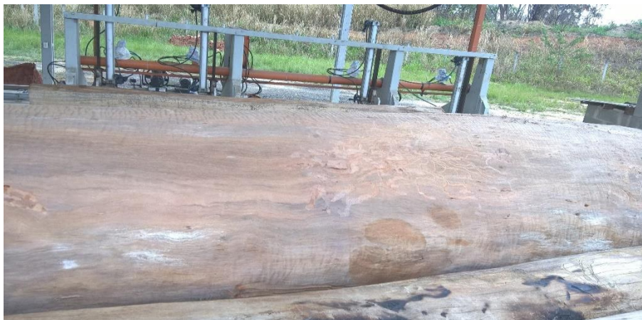
Figura 6- Tora de Eucalyptus spp. danificadas por insetos deterioradores Phoracantha spp. IF, UFRRJ, 2017.
