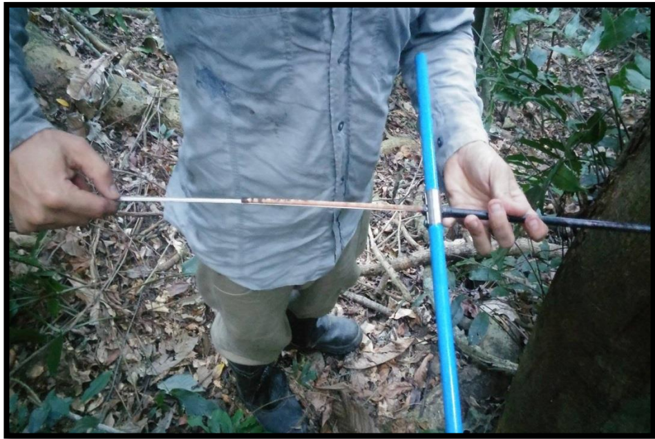
Figura 11: Retirada de bagueta por meio do trado de incremento para avaliação da densidade da madeira.
