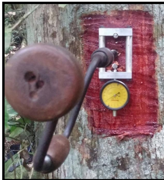
Figura 9: Extensômetro utilizado na obtenção das tensões residuais longitudinais.
