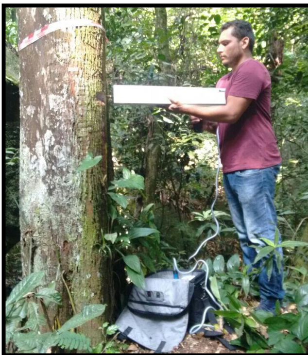
Figura 10: Medição da amplitude de resistência à furação da madeira utilizando o resistógrafo.
