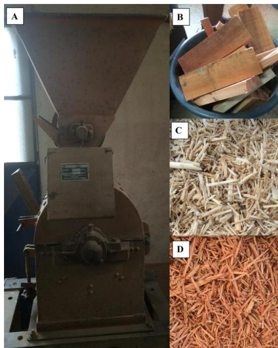
**Figura 1.** Moinho de martelo (A), Sarrafos de Eucalipto (B), Bagaço de cana-de-açúcar após processamento em moinho de martelo (C) e Eucalipto após processamento em moinho de martelo (D).
