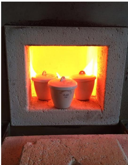
**Figura 5.** Briquetes sendo levados à mufla para análise dos teores de materiais voláteis (TMV), de cinza (TCZ) e de carbono fixo (TCF).
