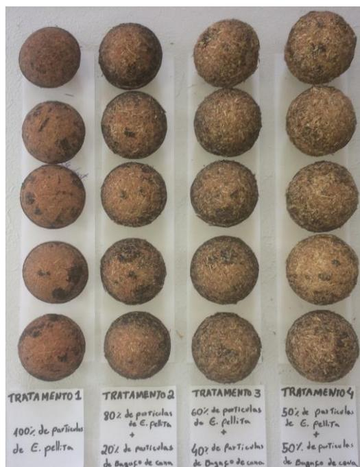
**Figura 8.** Briquetes expostos ao ar para o estabelecimento da umidade de equilíbrio com o ambiente.
