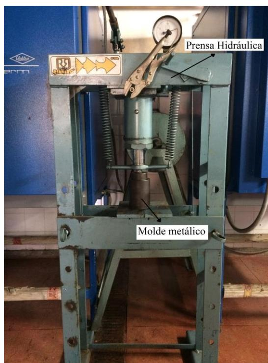
**Figura 4.** Prensa hidráulica e cadinho metálico utilizado como molde para os briquetes.
