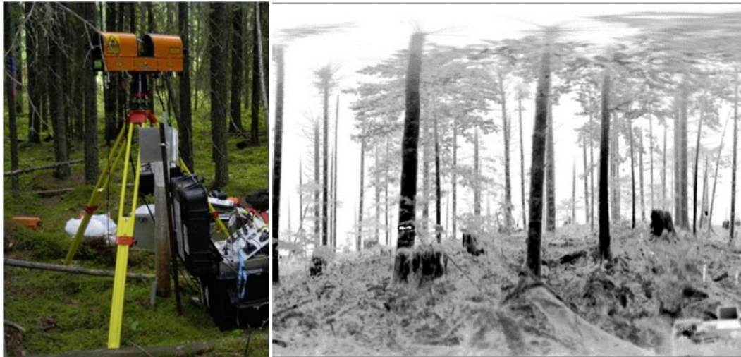
Figura 1 - Sistema de Laser Scanner terrestre e o resultado da capture de nuvens de pontos de alta intensidade.
