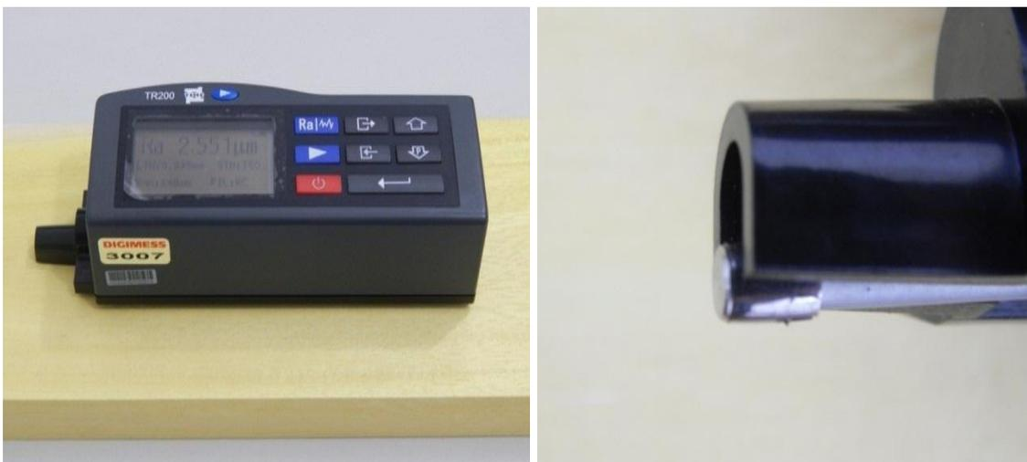
Figura 11. Instrumento de medição da rugosidade empregado para medição do acabamento superficial das amostras.
