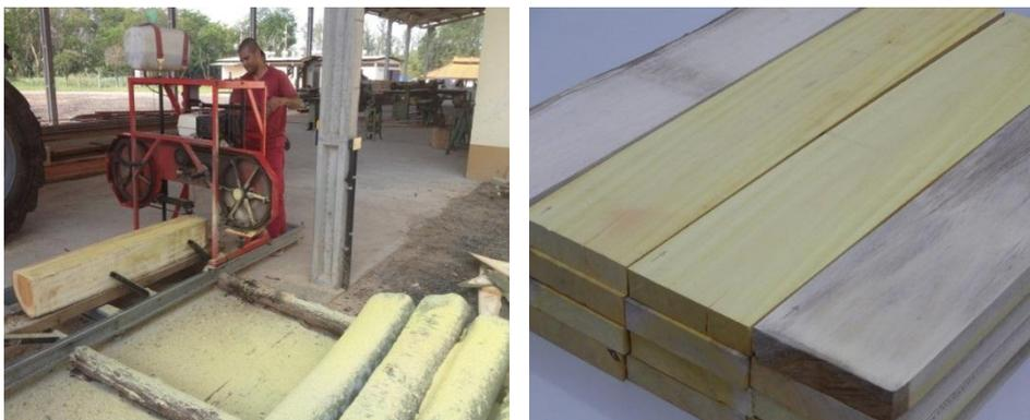
Figura 9. Desdobro primário sendo realizado com auxílio de serra-fita horizontal portátil e corpos-de-prova utilizados.
