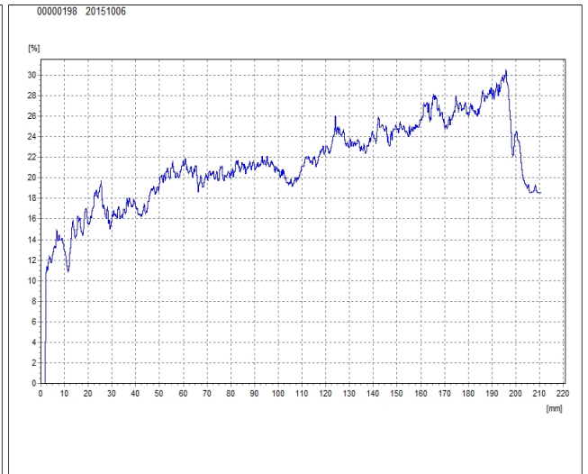
Figura 6 (continuação). Gráficos gerados pelo resistógrafo, mostrando a resistência à penetração percentual por distância percorrida em milímetros.
