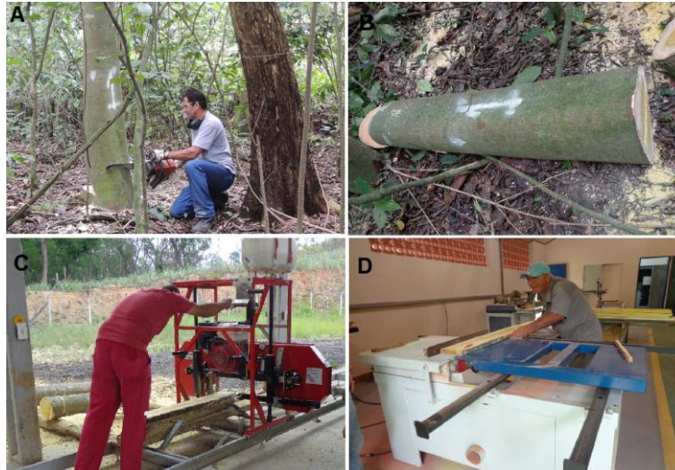
Figura 2. Obtenção e confecção do material de estudo. (A) abate das árvores, (B), toras de 1,30 m de comprimento, (C) desdobro das toras, (D) confecção dos corpos de prova.
