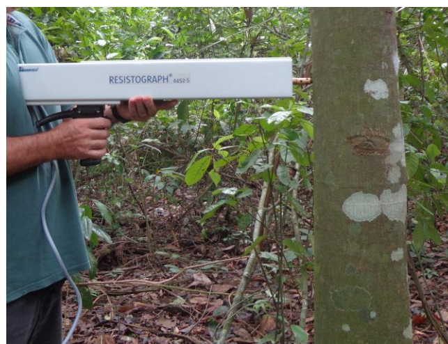
Figura 3. Resistógrafo em aplicação para a obtenção de dados de resistência à penetração de broca na madeira.
