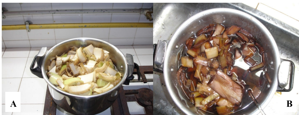
Figura 4 - Fragmentos de pseudocaulo de bananeira ( Musa sp) acondicionados no interior de uma panela de pressão de aço inoxidável, antes (A) e depois (B) do processo de polpação artesanal.
