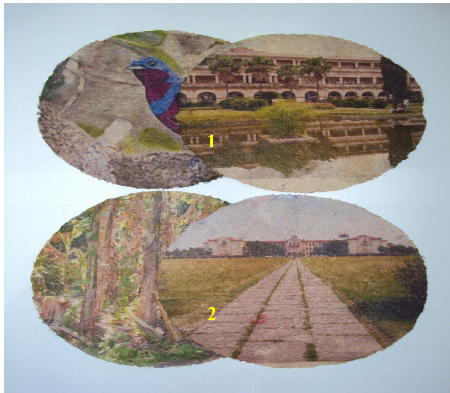
Figura 8 - Papéis da pasta celulósica do pseudocaule de bananeira ( Musa sp), submetidos à impressão, em que: 1 = concentração de NaOH de 1,5% e tempo de polpação de 30 min e 2 = concentração de NaOH de 2,5% e tempo de polpação de 60 min.
