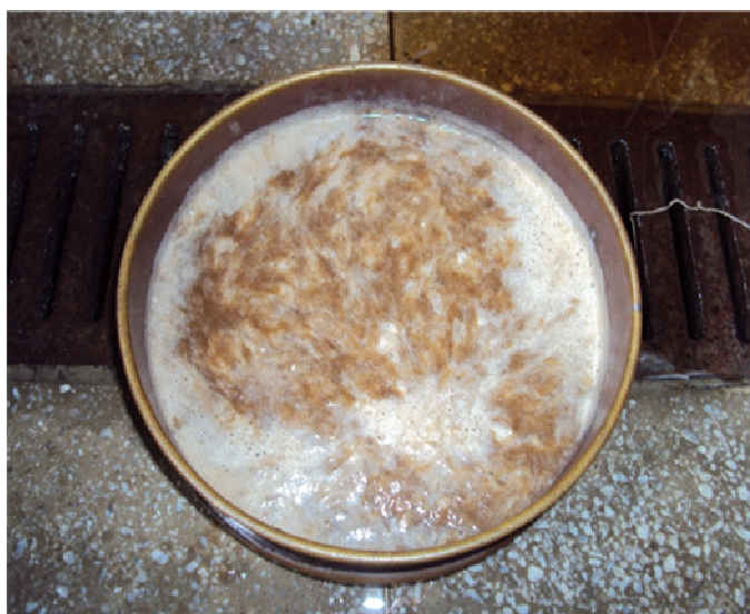
Figura 6 - Peneira com a malha de 1,0 mm, onde foi acondicionada a pasta celulósica bruta do pseudocaule de bananeira ( Musa sp ), para ser submetida à depuração através da injeção de fortes jatos d'água.
