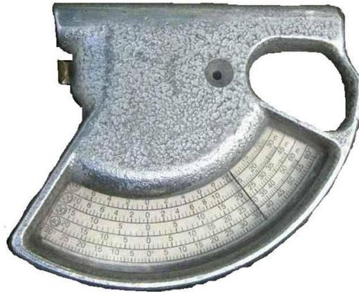
**Figura 4:** Clinômetro Blume-Leiss utilizado para medir a declividade nos ambientes estudados.
