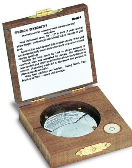
**Figura 3:** Densiômetro esférico utilizado para medir a abertura do dossel nos ambientes estudados.
