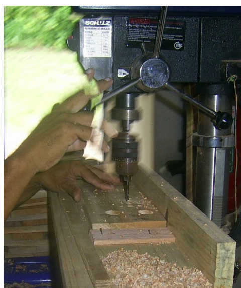
Figura 4. Operação de furação para cavilha dos corpos de prova.
