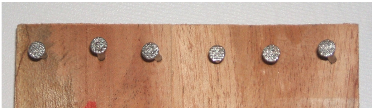
Figura 8. Exemplo do teste de fendilhamento por pregos.
