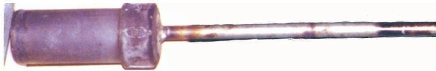
**Figura 1** - Cadinho metálico, utilizado durante a pirólise das matérias-primas lenhosas.
