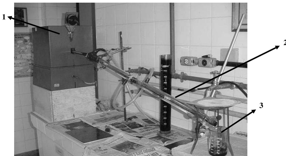
**Figura 2** - Sistema adaptado para a pirólise das matérias-primas lenhosas.
