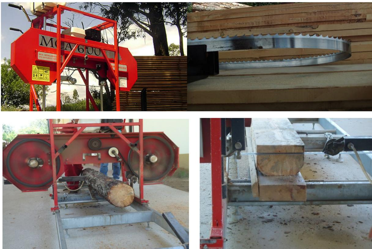
Figura 7. Serra portátil MCA 600, detalhes da lâmina de pequena espessura e do funcionamento do equipamento.
