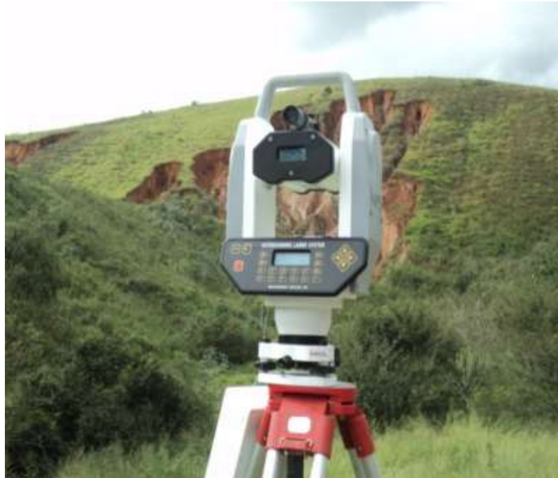
Figura 2 - Laser scanner utilizado nesse estudo. Ao fundo pode-se observar uma das voçorocas que foram varridas.
