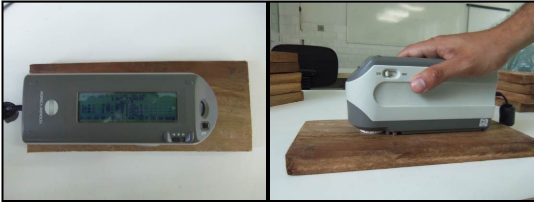
Figura 7. Espectrofotômetro portátil CM-2600d da Konica Minolta, utilizado nas medições de cor nas amostras de madeira ( Corymbia citriodora ).
