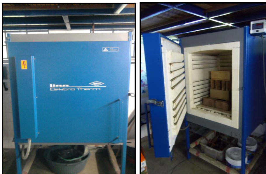
Figura 2: Mufla, modelo Linn Elektro Therm utilizada no processo de termorreificação.
