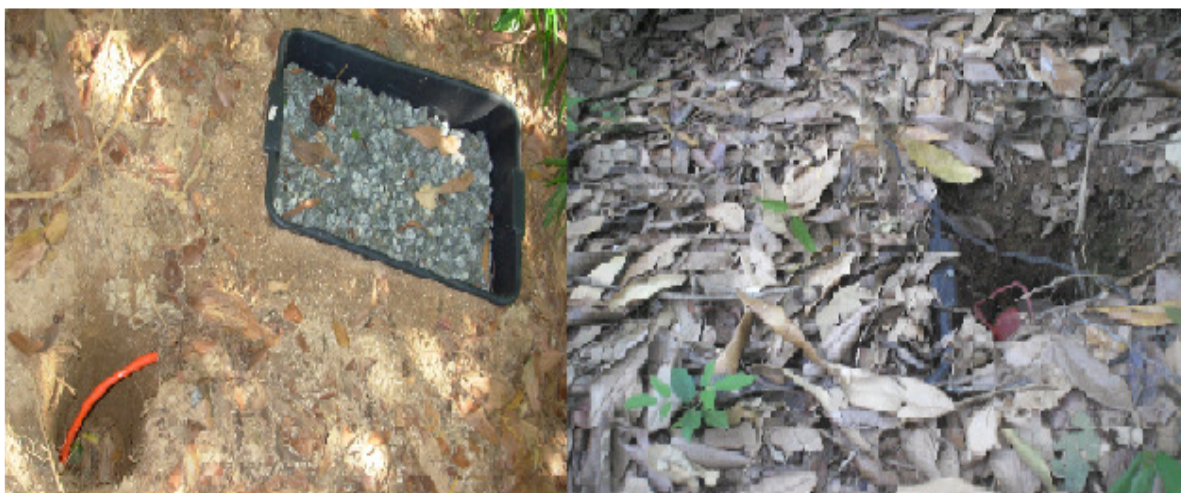
Figura 07: Foto do interceptador instalado no subsolo antes da acomodação de Serrapilheira (esquerda) e Interceptador já instalado sob a camada de Serrapilheira (direita).
