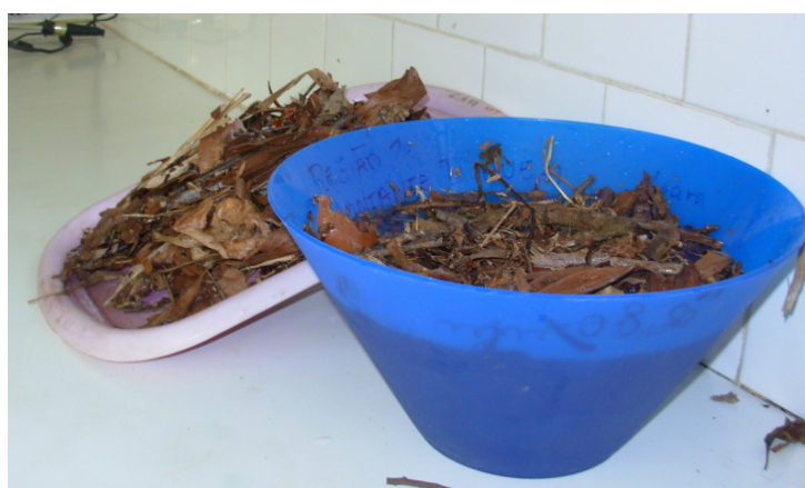
Figura 05: Foto da imersão da Serrapilheira em água (primeiro plano) e drenagem dos excessos (fundo).
