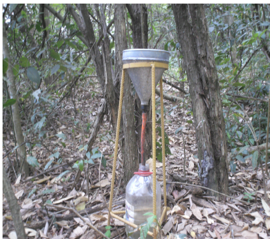
Figura 06: Pluviômetro instalado no interior da Medida Biológica 05.
