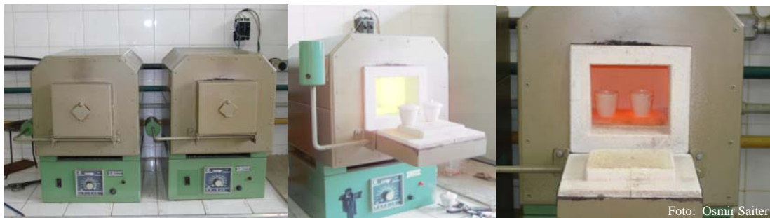
Figura 9: Mufla utilizada para análise química imediata do carvão vegetal
