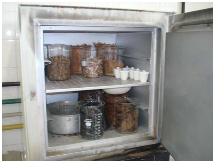
Figura 4: Estufa utilizada na secagem a 105 \pm 3^\circ\text{C}
