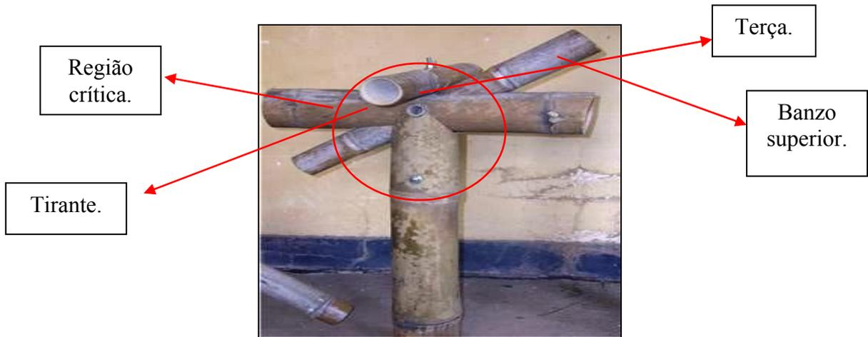
**Figura 29.** Protótipo da junção do banzo superior com o tirante e a terça.
