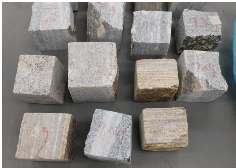
Figura 4. Blocos de paragnaisse e ortognaisse milonítico utilizados nos ensaios tecnológicos
