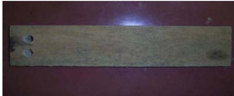
Figura 10. Corpo-de-prova do teste de broca avaliado com nota 2 (leve, superfície com queima da madeira, arrancamento de grã, grã felpuda e esmagamento de grã em uma parte pequena da peça).
