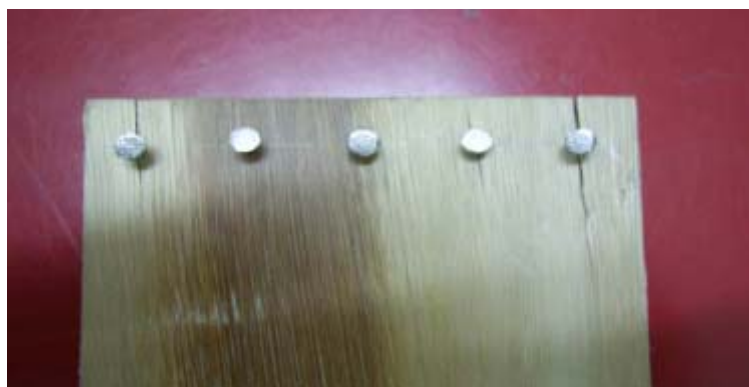
Figura 12. Corpo-de-prova do teste de fendilhamento por pregos com rachas.
