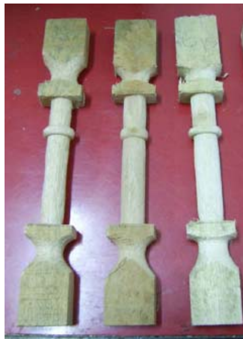
Figura 11. Corpos-de-prova do teste de torno avaliados com nota 3 (severa, presença de arrancamento de grã, grã felpuda e/ou superfície enrugada, em grande parte da peça ou em toda ela).
