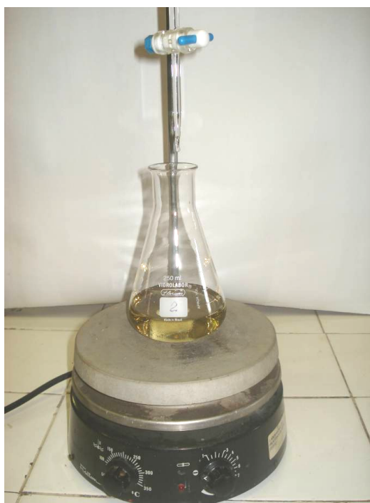
Figura 13: Preparo do colóide de nanopartículas de prata.
