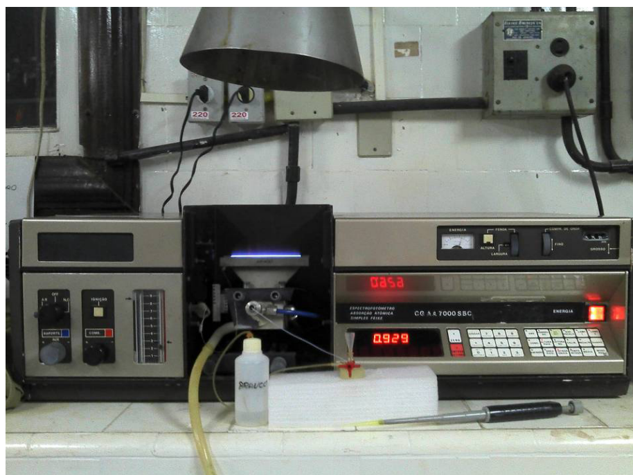
Figura 15: Sistema de microinjeção acoplado ao espectrofotômetro de absorção atômica.
